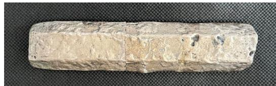
図 2 Cu-23%Sn-Ni 合金試験体.
