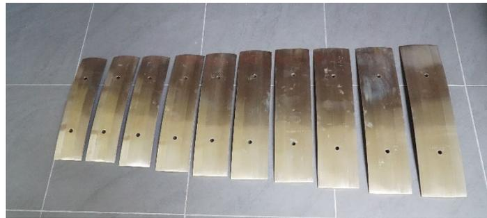
図7 製作した試験用音板。
