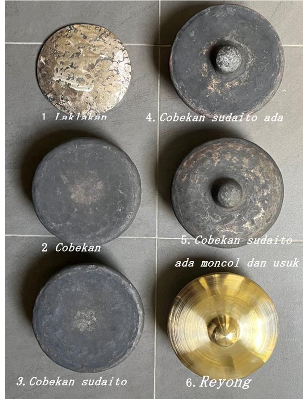
図4 鍛造試験体
